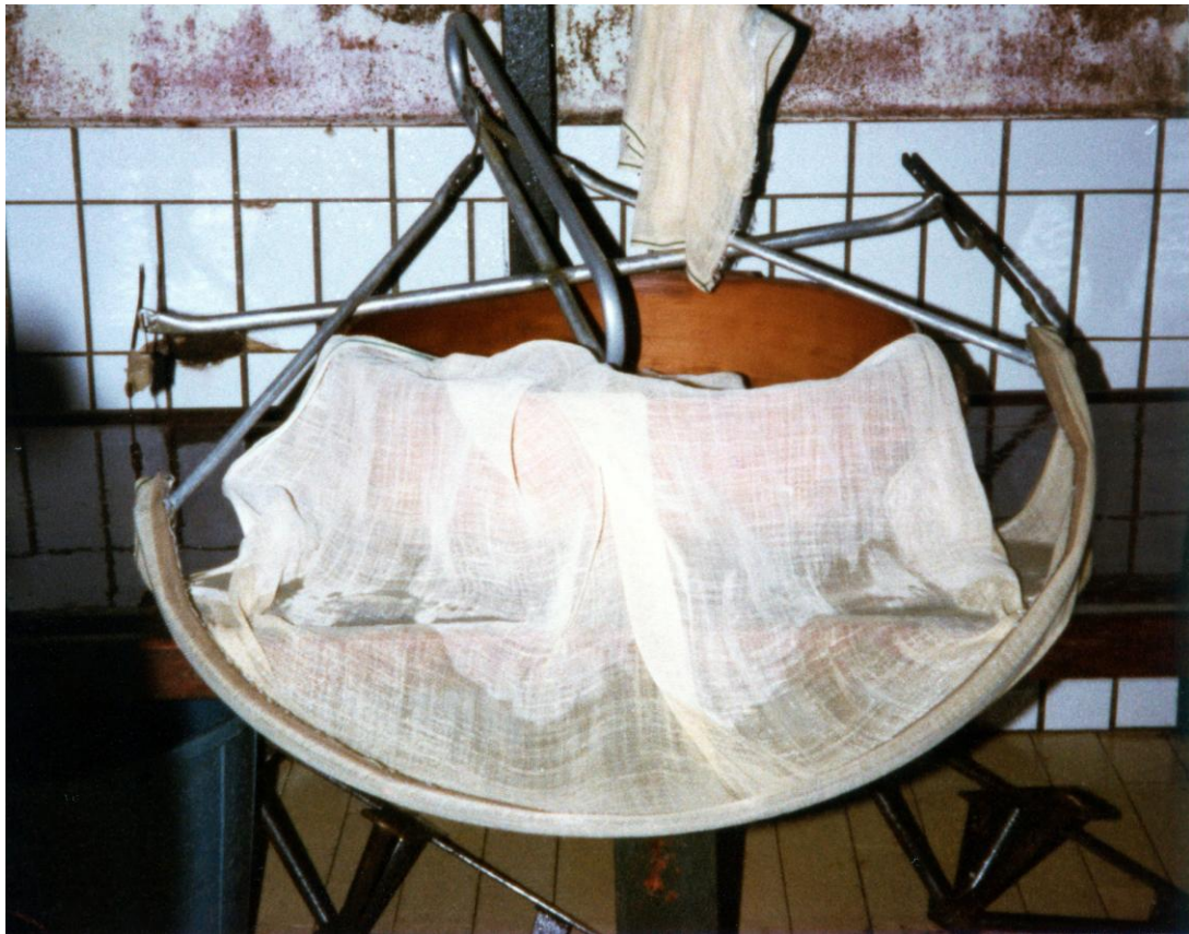
Avec cette toile montée sur un arc de cercle, le lait caillé va être séparé du petit-lait
