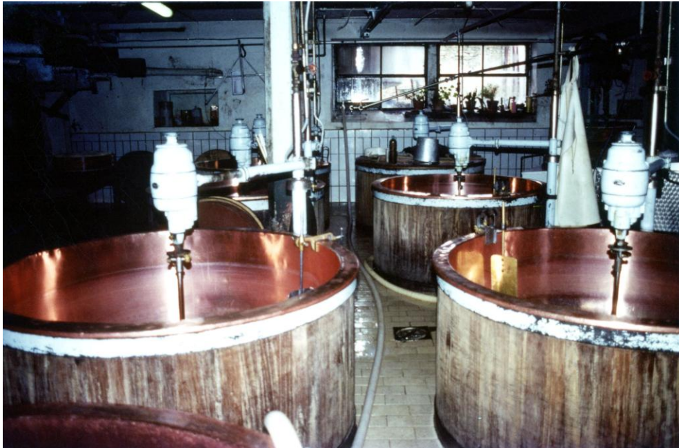
Les cuves, en cuivre, sont prêtes pour accueillir le lait, chacune permettra de fabriquer une meule d'Emmental
